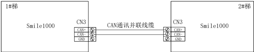
图 5-12 并联接线示意图
